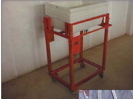
Figura 12 - Suporte para caixote de argamassa
