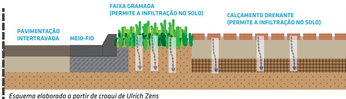
De forma adicional e complementar, outro procedimento de controle de escoamento nas parcelas, corresponde à implantação e manutenção de uma faixa não impermeabilizada entre as áreas de passeio nos lotes, e o meio-fio das vias públicas.
