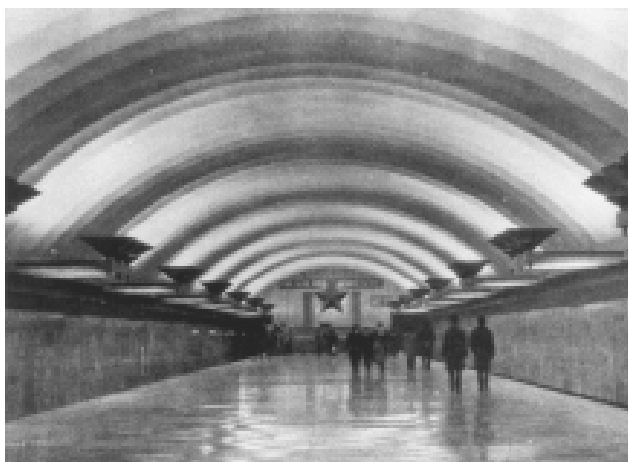
FIGURA 14 - Abóbadas de armocimento - URSS (vão = 17 m)
