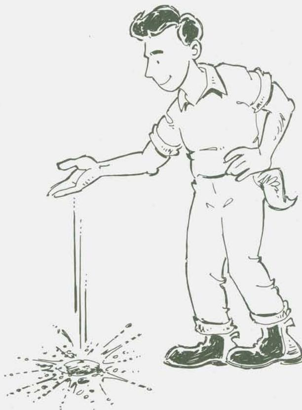
FIGURA 14 - Avaliação da umidade da mistura pelo teste do esfarelamento do bolo
