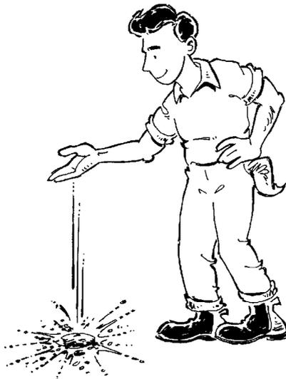
FIGURA 7 - Avaliação da umidade da mistura pelo teste do esfarelamento do bolo
