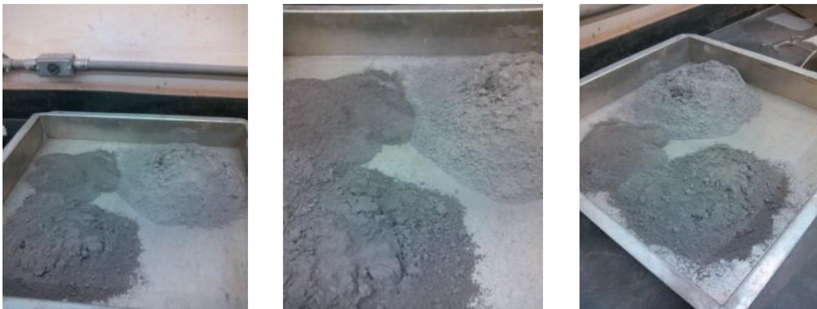
Figura - Amostra de escória que passou na peneira nº 200 com tonalidades diferentes.
