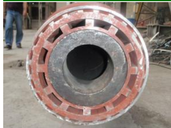
Cabeças de Queima com Seções Anulares de Injeção
