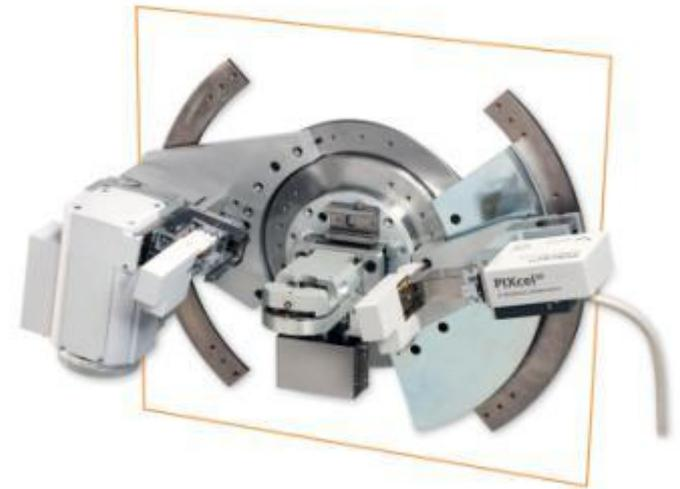
Técnica analítica versátil, não destrutiva, permite identificação e determinação quantitativa de compostos cristalinos em amostras sólidas ou em pó
