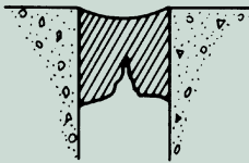
Falta de coesão
