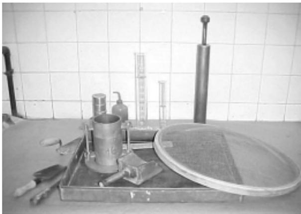
FIGURA 7b - Equipamento para ensaio de compactação
