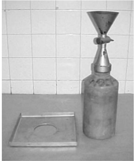
FIGURA 9b - Equipamento para o ensaio do frasco de areia
