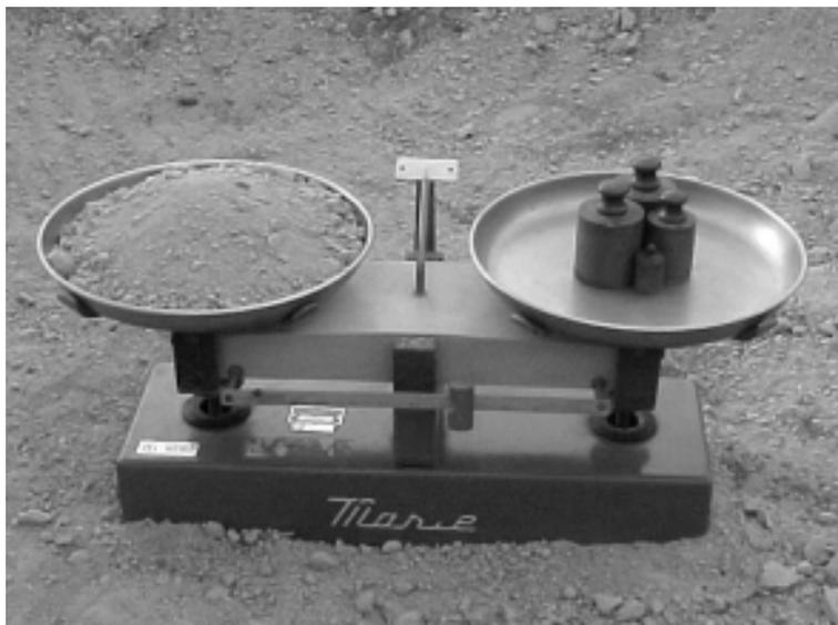
FIGURA 2b - Execução da pesagem da amostra total
