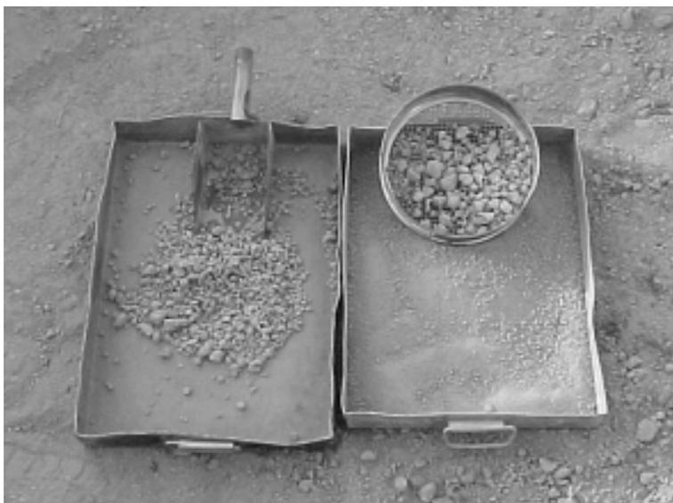
FIGURA 2d - Peneira nº 4, material nela retido e material passando
