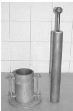
FIGURA 7a - Equipamento para ensaio de compactação
