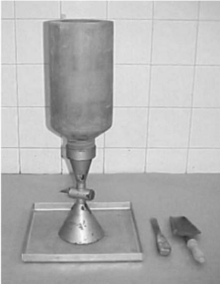
FIGURA 9a - Equipamento para o ensaio do frasco de areia
