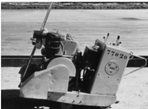
**FIGURA 6** - Serra de disco diamantado
