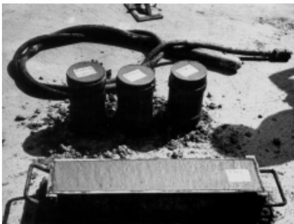
**FIGURA 75** - Corpos-de-prova cilíndricos e prismáticos para o controle das resistências mecânicas
