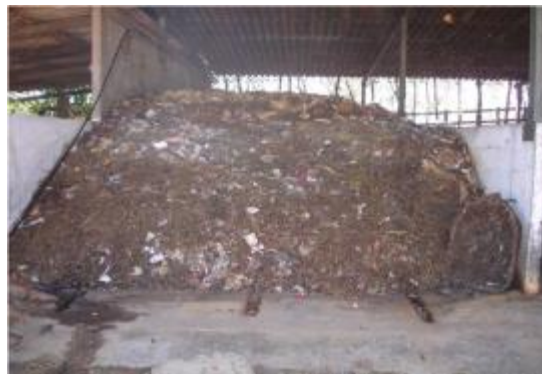
Figura 2 – Silo com a leira de compostagem
