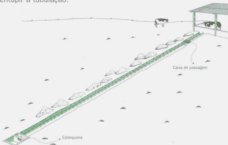
A chorumeira nada mais é que um reservatório onde a água servida é armazenada por alguns dias. Pode ser construída enterrada, reduzindo custos e facilitando a execução.
