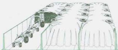
Em regiões planas, onde o silo-trincheira se torna inviável, pode ser construído o silo do tipo **bunker**, que não exige escavações. Consiste de elementos pré-moldados de concreto que dispensam o uso de contrafortes. Entretanto, esse material é um pouco
