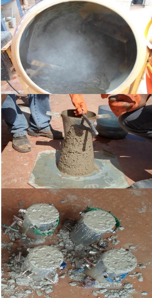
Para a devida verificação deste projeto, utilizamos 10 traços de concreto. Para cada traço foram feitos quatro copos de prova, sendo dois destinados ao ensaio de resistência à compressão e os outros dois de resistência à tração, todos com as mesmas dimensões, variando apenas na porcentagens do material fresado e da brita.
