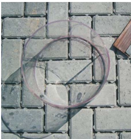
Figura 11 - Cilindro acrílico posicionado no pavimento permeável para realização do ensaio para determinação do coeficiente de permeabilidade.
