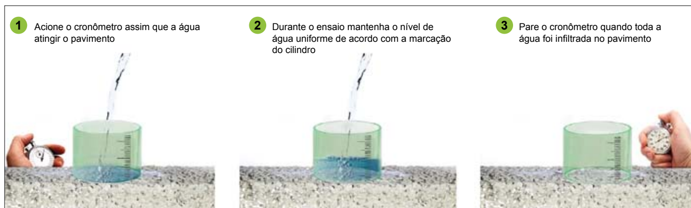
Figura 7 - Esquema para medição de coeficiente de permeabilidade in situ .
