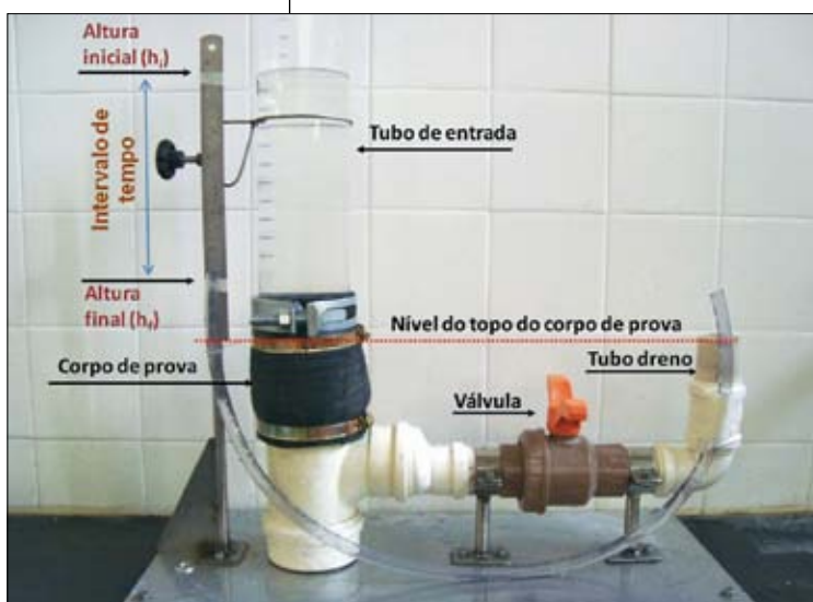
Figura 6 - Permeâmetro de carga variável para determinação do coeficiente de permeabilidade do concreto permeável
