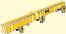
A yellow and black vibratory screed machine with a long horizontal beam and two sets of wheels at the ends. | <p><i>Indústria de pré-moldados.</i></p>                           | <p><i>Ajustar a frequência de vibração em função das dimensões das fôrmas e da dosagem do concreto.</i></p> | <p><i>Painéis, pré-moldados, aduelas de concreto e postes.</i></p>                                  |
