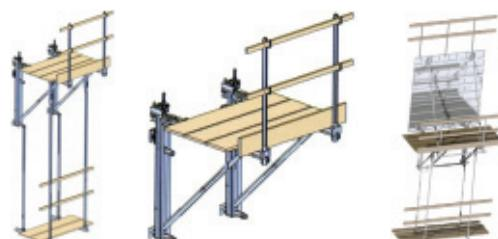
O Sistema Lumiform SH de estrutura e chapas de alumínio, com console de trabalho e guarda-corpo, foi analisado e verificou-se a necessidade de instalação de rodapé de 0,20 m, tal como nos desenhos, e telas entre os travessões para que se adéque à NR 18.
