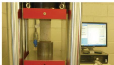
Rompimento de corpo-de-prova
