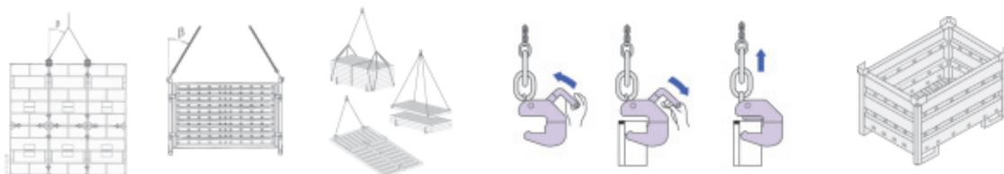
Quanto aos outros sistemas de fôrmas que necessitam ser içados por grua, analisar o coeficiente de redução da resistência da eslinga em função dos ângulos formados pelos cabos, correntes ou cintas e adotar as disposições mais adequadas das eslingas para garantir a estabilidade do conjunto contra rajadas de vento. É preciso assegurar que os pontos indicados para conexão dos cabos para içamento do conjunto estão adequados e seguros.
