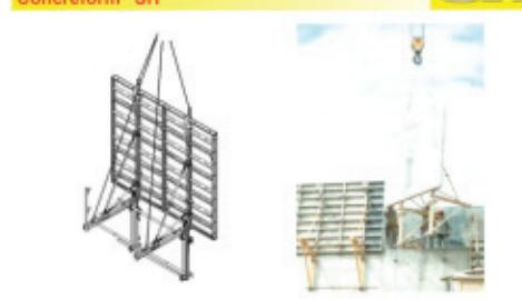
**Movimentação vertical – módulo Concreform® AS-150**
