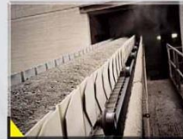
TP клинкерный лотковый конвейер TP clinker pan conveyor
