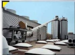
TRS односторонний ленточно-цепной конвейер TRS single drag-chain conveyor
