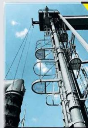
CV вертикальный винтовой питатель CV vertical screw feeder
