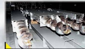
CO винтовой конвейер CO screw conveyor
