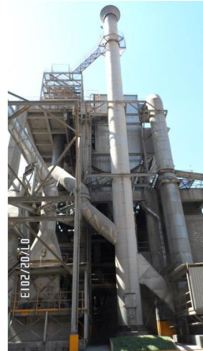
**Figura 4. Filtro de mangas do coque da cimenteira em Apaxco.**
