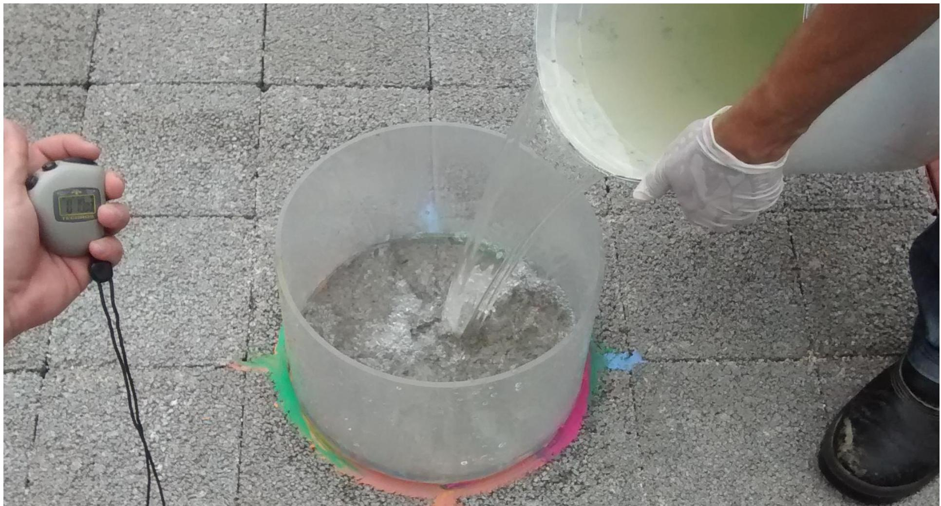
Antes da liberação deve-se fazer o teste para medir o coeficiente de permeabilidade do pavimento permeável. Norma ABNT NBR 16416
