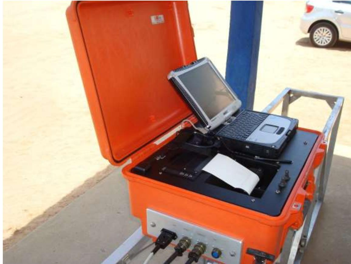
**Os movimentos da roda censa são captados por um transdutor e um odômetro e enviados a um computador que grava os desvios do plano de referência, traçando o perfil do pavimento**
