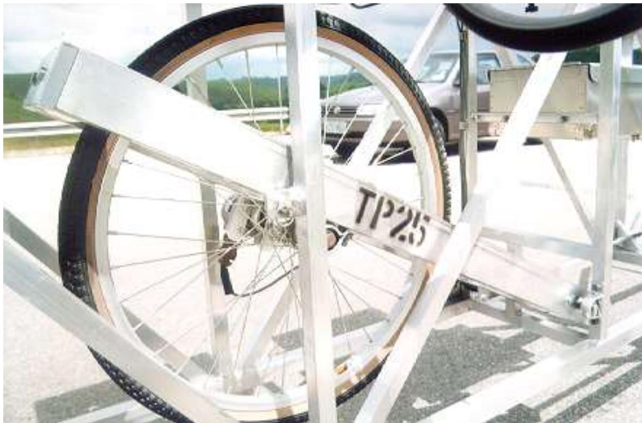
**Dotado de roda censorsa, localizada no meio da estrutura, livre para movimentar-se verticalmente**
