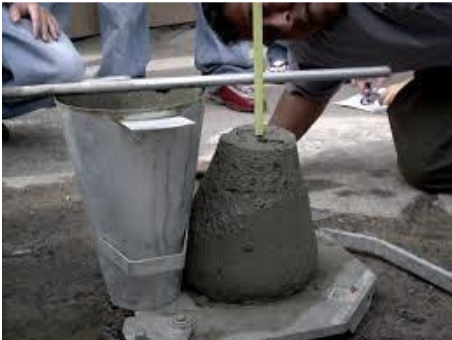
Determinação da consistência pelo abatimento do tronco de cone NBR NM 67
