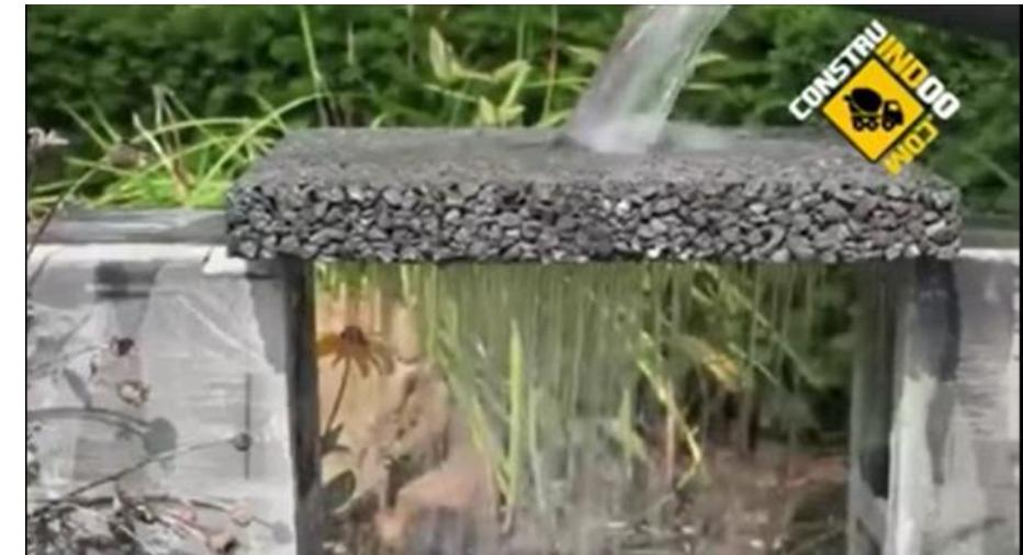
**Pavimento Intertravado permeável com juntas alargadas**
