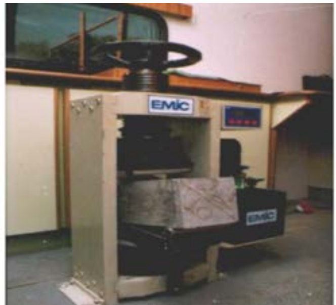
Ensaio de resistência à tração na flexão, em corpos de prova prismáticos, com carga aplicada nos terços médios, por meio de dois cutelos, segundo a norma ABNT NBR 12142:2010.
