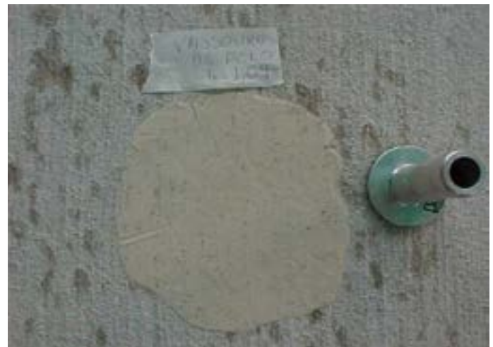
Ensaio de Mancha de Areia (ASTM E 965:2015).
