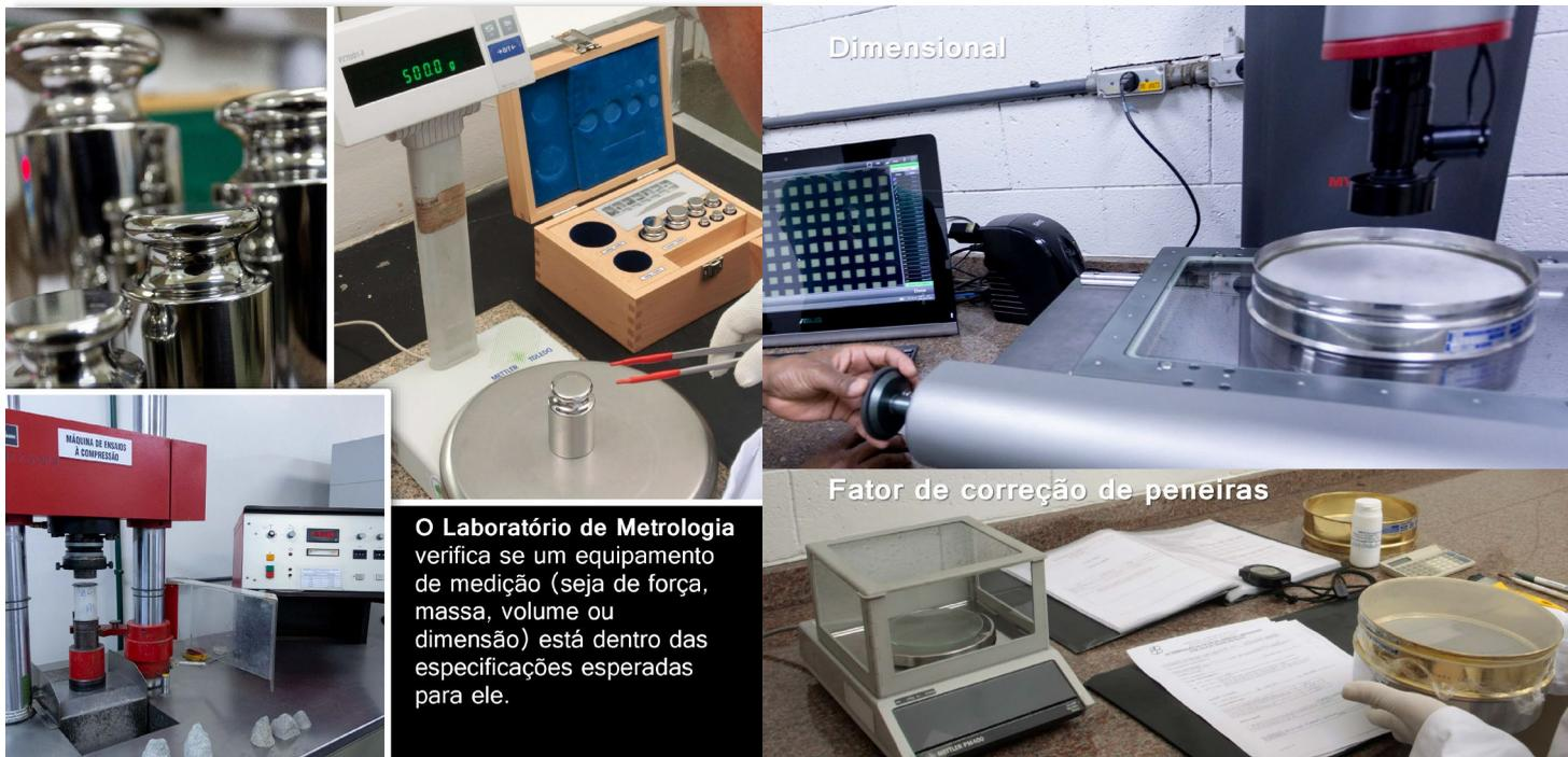
O Laboratório de Metrologia verifica se um equipamento de medição (seja de força, massa, volume ou dimensão) está dentro das especificações esperadas para ele.
