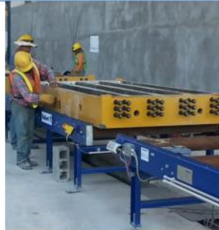
Dormentes de concreto protendido para o continente americano. Foto: Vollert
